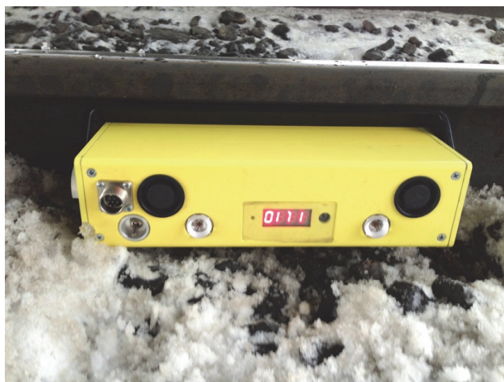
Рисунок. Устройство оповещения о приближении поезда «Сигнализатор-П»
