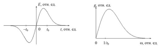
Рис. 1. Поле и спектр однопериодного импульса
