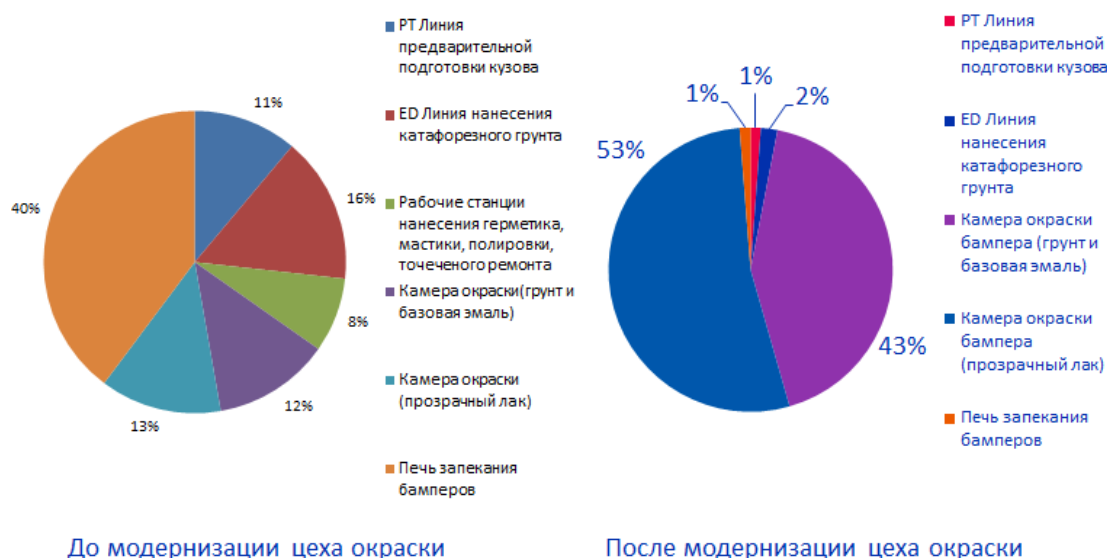
Рис. 9. Потребление воздуха на участке окраски до и после модернизации
