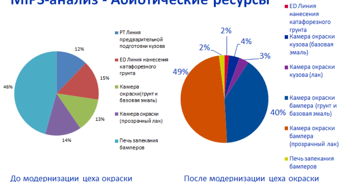
Рис. 7. Потребление абиотических ресурсов на участке окраски до и после модернизации
