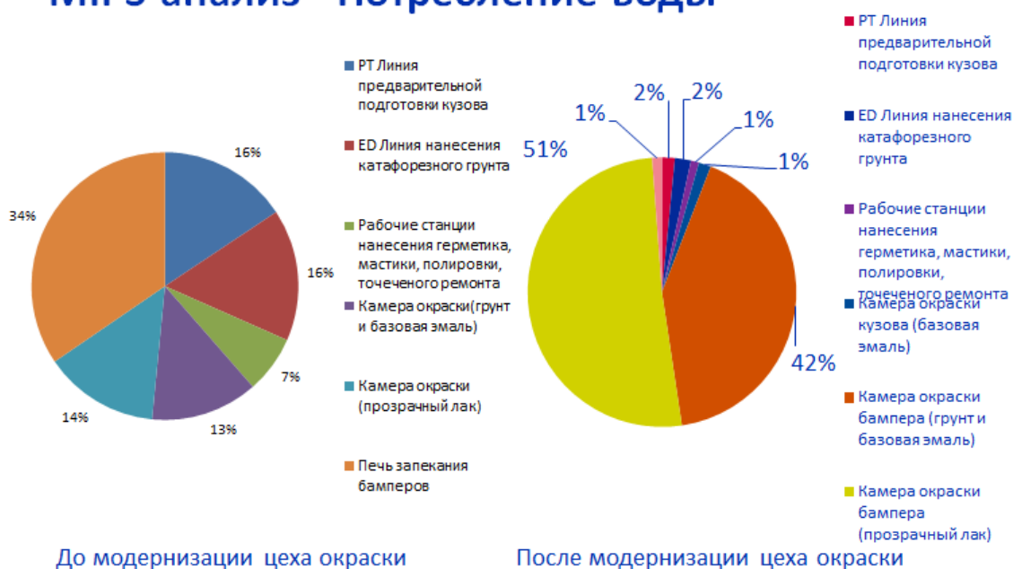
Рис. 8. Потребление воды на участке окраски до и после модернизации
