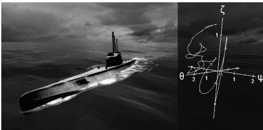
Рис. 3. Исследование режимов качки морского объекта (с отображением трехмерной фазовой диаграммы крен–дифферент–возвышение центра тяжести)
