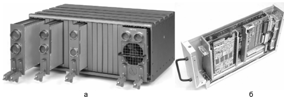
Рис. 2. Крейт модульной авионики разработки Rockwell Collins (а) и модуль IMA разработки National Aerospace Laboratory (Голландия) (б)
